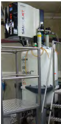
Abbildung 2: Das in diesem Projekt zum Einsatz kommende NMR Spektrometer (links) liefert hochaufgelöste NMR Spektren der zu untersuchenden GCKD Plasmaproben (rechts). Signale im Spektrum reflektieren bestimmte Metabolite, die aufgrund ihrer Signalposition auf der x-Achse identifiziert werden können. Die Signalhöhe auf der y-Achse reflektiert die Konzentration eines Metaboliten in der untersuchten Plasmaprobe. Die Metabolite, z. B. Kreatinin, können durch Vergleiche mit Referenzspektren identifiziert werden (s. Vergrößerung des hellblau markierten Spektrumausschnittes). (Quelle: Helena U. Zacharias und Wolfram Gronwald).
