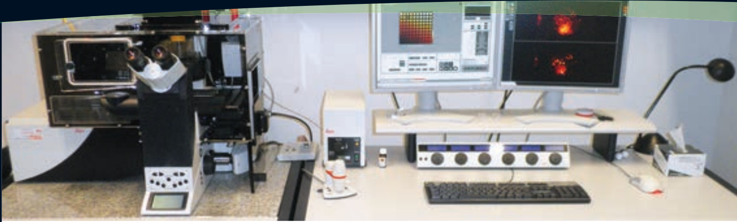
Abbildung 2: Automatisches konfokales Mikroskop „TCS SP5“ von Leica mit Inkubationskammer für Lebendzellaufnahmen (Foto: Nina Beil).
